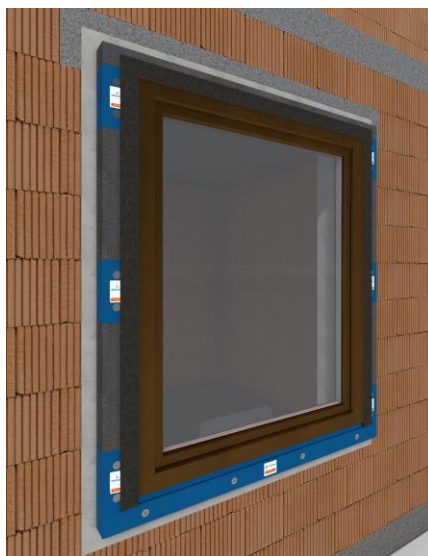
Obr. 2.1.1 – Vizualizace principu osazení hranolů pro předsazenou montáž běžného okna u systému PROPASIV [Zdroj: https://www.propasiv.cz/technicka-dokumentace/ ]
